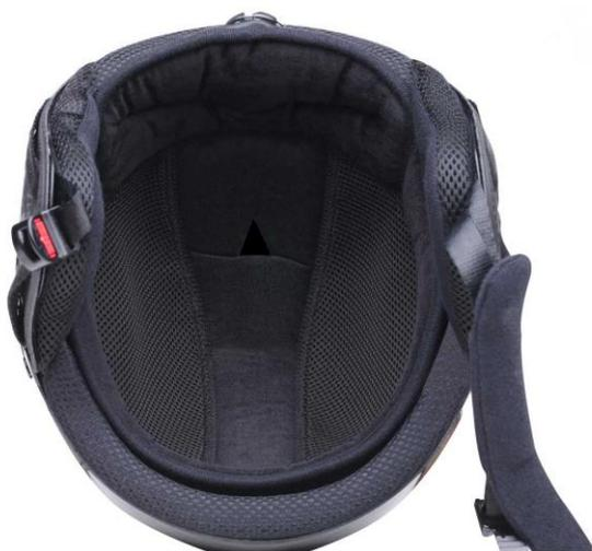
La doublure de confort Nerv 2.0, composée d'une coiffe en **Coolmax**, est fixée à la coque intérieure en polystyrène au moyen d'une série de bandes Velcro. Elle est facile à enlever. Veillez à **détacher les bandes Velcro en tenant et en tirant sur les bandes elles-mêmes. Ne retirez pas simplement la coiffe intérieure du casque.**
